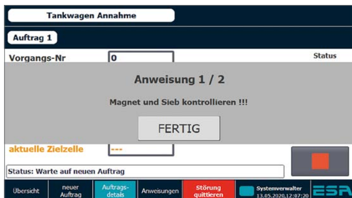
Abb. 4: Qualitätssicherung von Anfang an: Alle Silorohstoffe laufen bei der Anlieferung sowohl über ein Sieb als auch über einen Magneten und werden über eigens zugeordnete Blasleitungen eingelagert.
